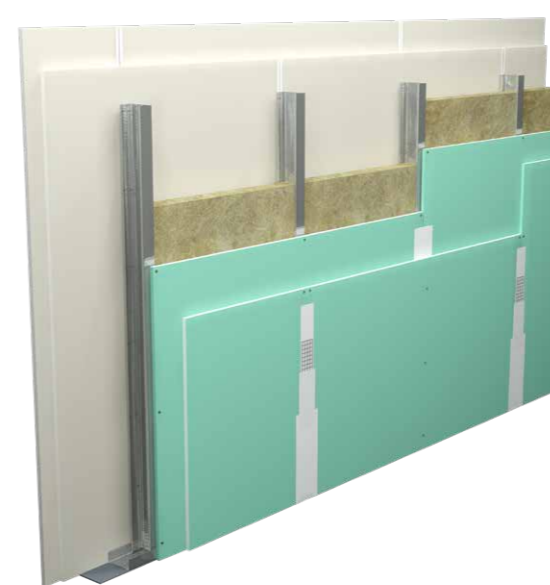
Vaade seinale kõrgendatud niiskustasemega ruumi küljelt (nt vannituba, köök)
